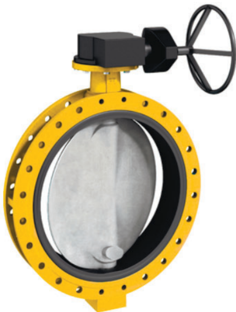
Двухфланцевый дисковый затвор с эластичным седлом небольшой габаритной длины с допуском DVGW для использования в газопроводных сетях.
