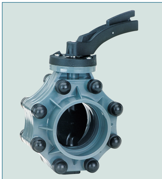
Пластиковый поворотный затвор К 016 DN 100 с растровой фиксирующей ручкой
