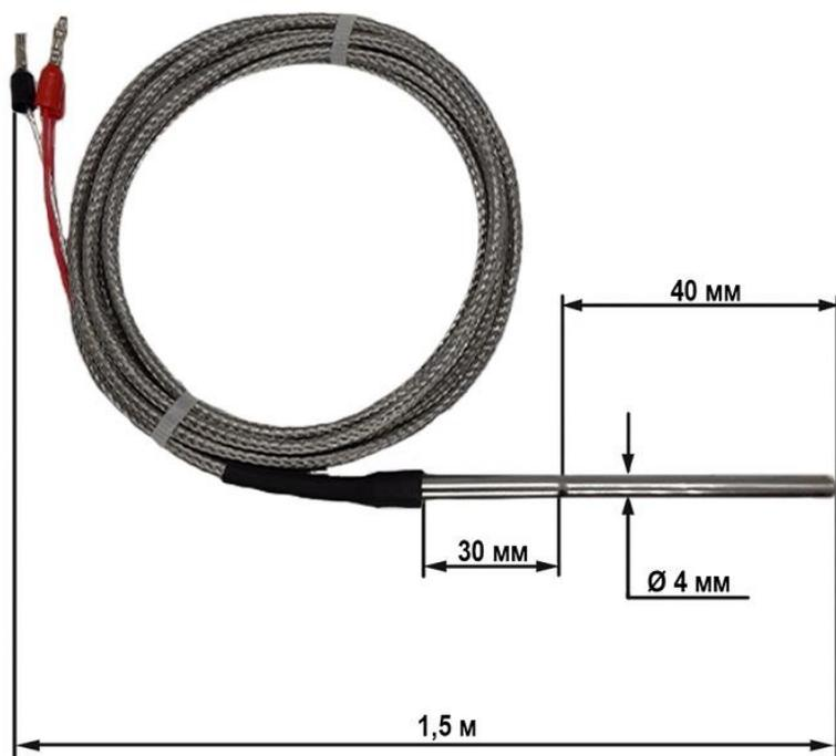
РТ-100 — выносной термодатчик для эксплуатации с регуляторами температуры. Чаще всего его покупают для комплектации приборов CRT-06 и CRT-05. Для подключения к этим регуляторам он укомплектован гибким кабелем, экранированным металлической оплеткой.
